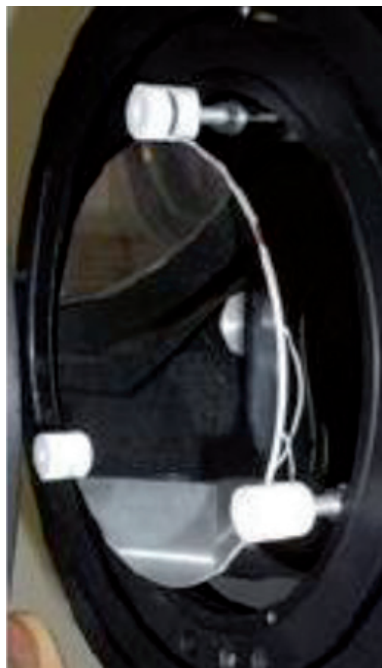
Realizované zrcadlo - zmenšený prototyp s 19 elektrodami
